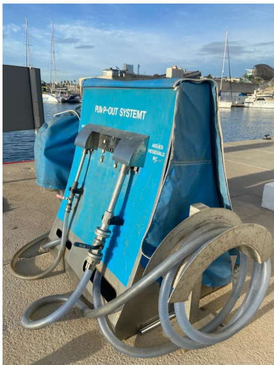
Equipo de succión de las aguas residuales y las sentinas de las embarcaciones
