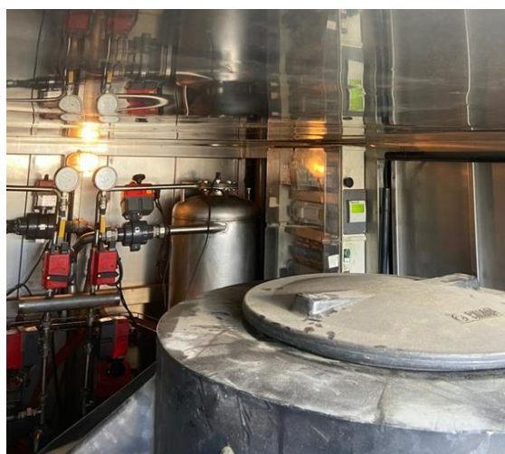
Depósito de sentinas y sistema de decantación
