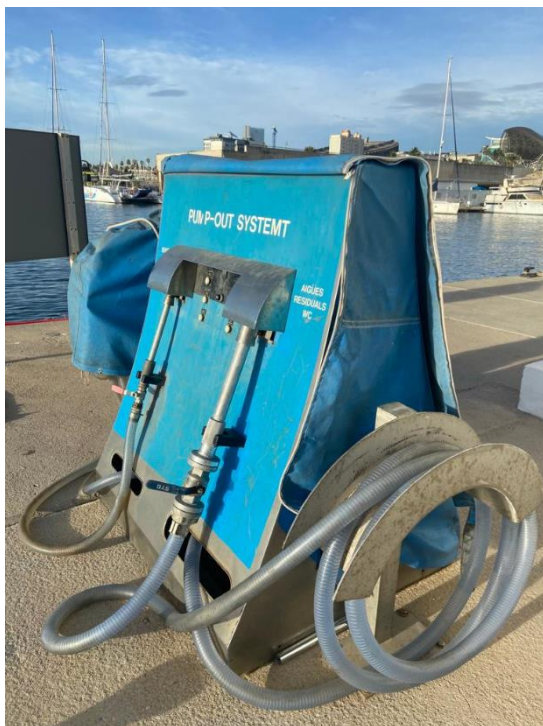
Equip de succió de les aigües residuals i les sentines de les embarcacions
